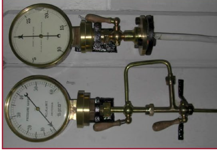
Meterjes die de druk in de ketel en de cilinder aangeeft.
