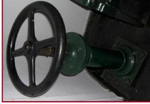
Dit wiel regelt hoeveel stoom er in de cilinder wordt gelaten.
